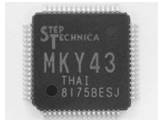
写真2 LSI「MKY43」 複数のCPUから複数のメモリをまるで一つのメモリかのようにアクセスできる
